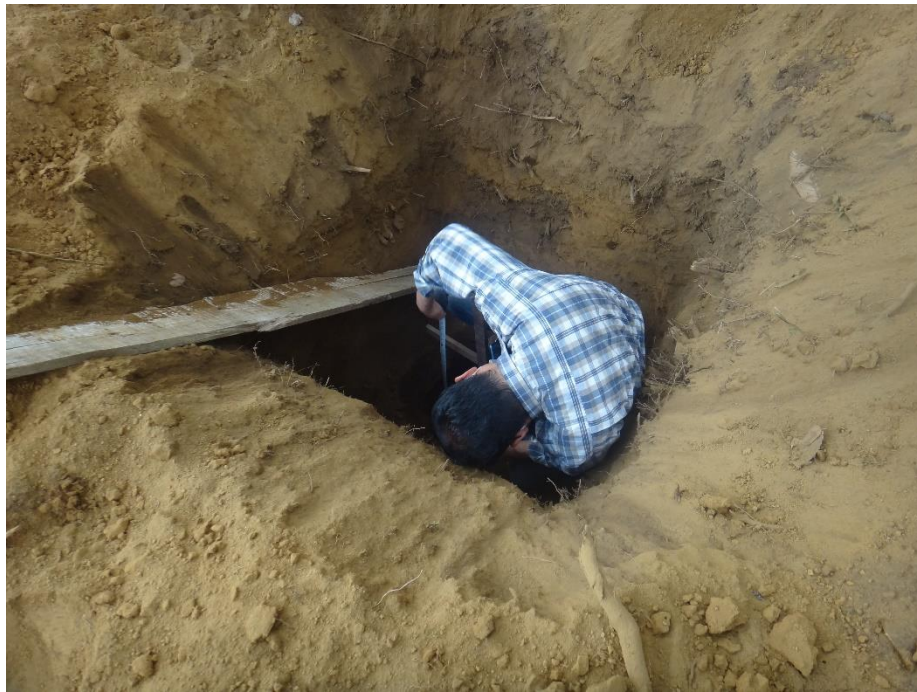
Realizando la medición del descenso del agua en el tiempo.
