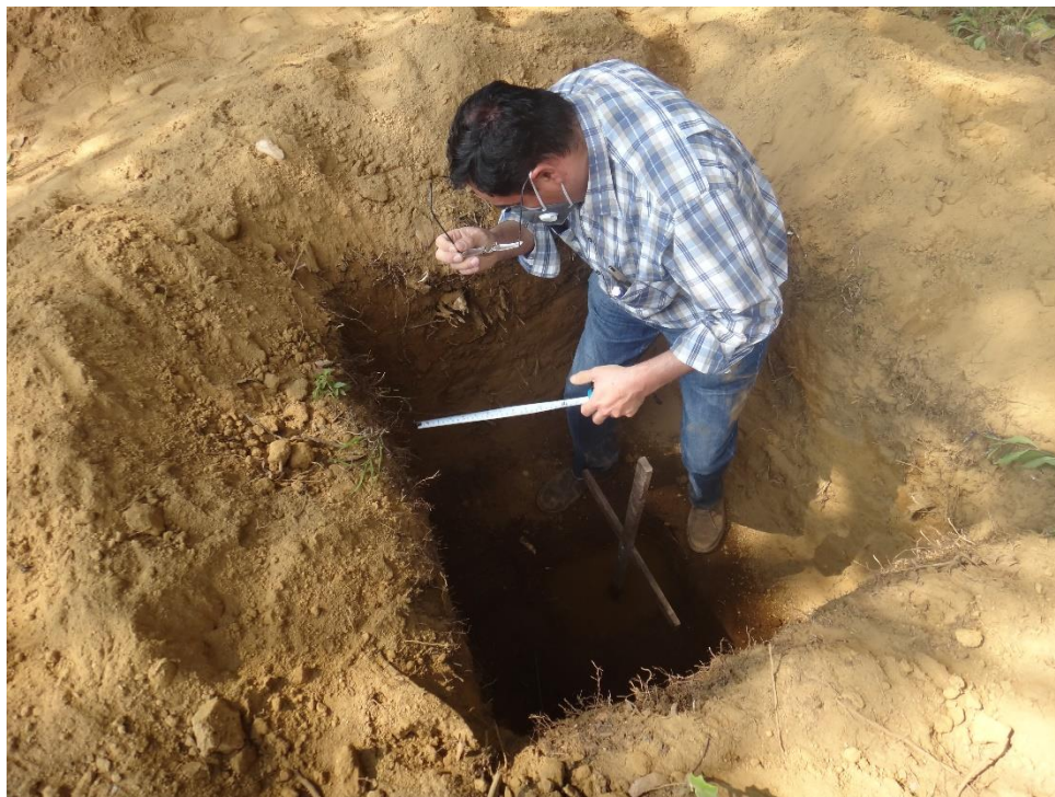
Realización de las pruebas de infiltración del suelo
