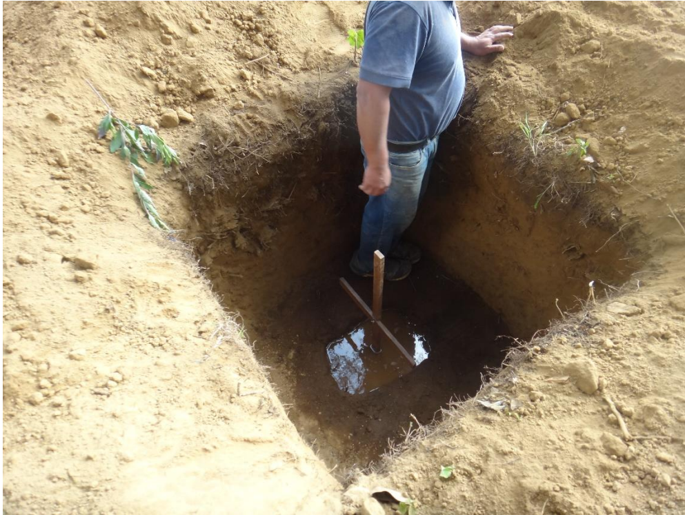
Realización de las pruebas de infiltración del suelo
